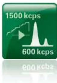
新一代混合脉冲处理器是第六代QUANTAX产品的关键组成。它具有超快的信号处理速度，在任何计数率下都保证稳定可靠的结果。可处理高达600kcps的输出计数率及1,500 kcps的输入计数率。
